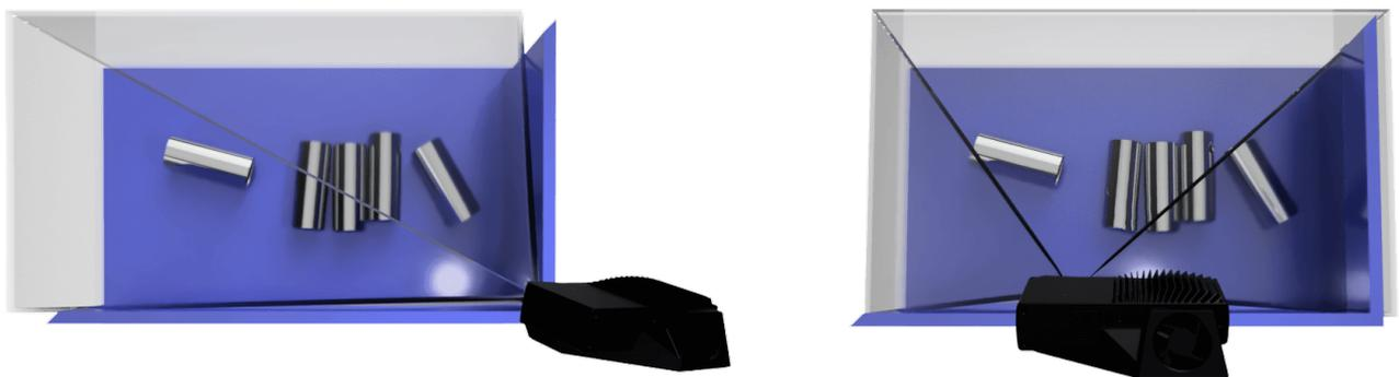
このようにカメラを取り付けると、ビンの壁からの相互反射が最小限に抑えられ、シーンの上部のスペースが解放されるため、ツールやロボットがアクセスしやすくなります。
