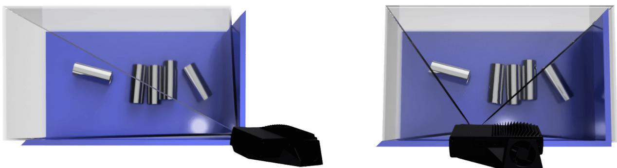
このようにカメラを取り付けると、ピンの壁からの相互反射が最小限に抑えられ、シーンの上部のスペースが解放されるため、ツールやロボットがアクセスしやすくなります。
