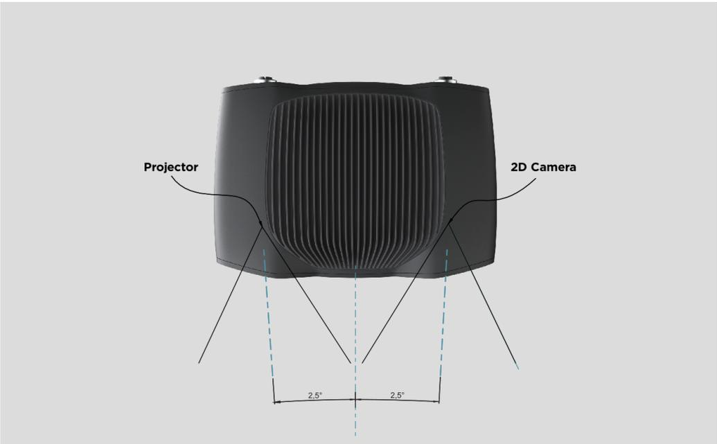
如果条件允许，请稍微倾斜相机的安装角度，以避免来自背景的反光和干扰，这也释放了场景上方的空间，便于机器人和工具的进入。
