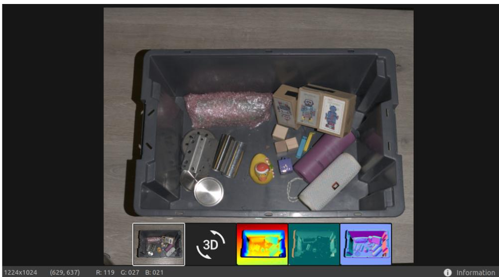
当使用不同的像素采样进行 2D+3D 捕获时，您可以在左上角的下拉菜单中在 2D 捕获和 3D 捕获的 2D 图像之间切换。
