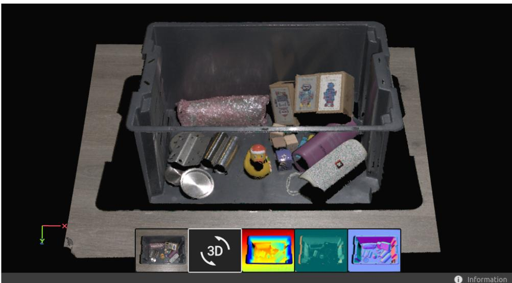
在此视图中打开和关闭颜色（C、D 和 R）及网格化（M）有助于评估点云质量。点大小也可以通过左上角的下拉菜单进行调整。例如，调整点大小有助于检查纹理很重要的区域。如果您已启用感兴趣区域，您还可以在下拉菜单中修改其可见性。
