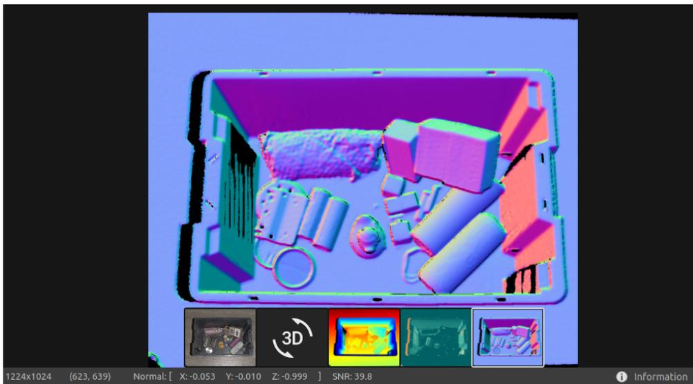
法線マップは、RGBカラーコンポーネントが法線ベクトルを表すシーンの表面法線の2D表現を提供します。カラーグラデーションによって表面の曲率、表面のテクスチャ、オブジェクト間の遷移が適切に表現されるため、これらを検査するのに役立ちます。
