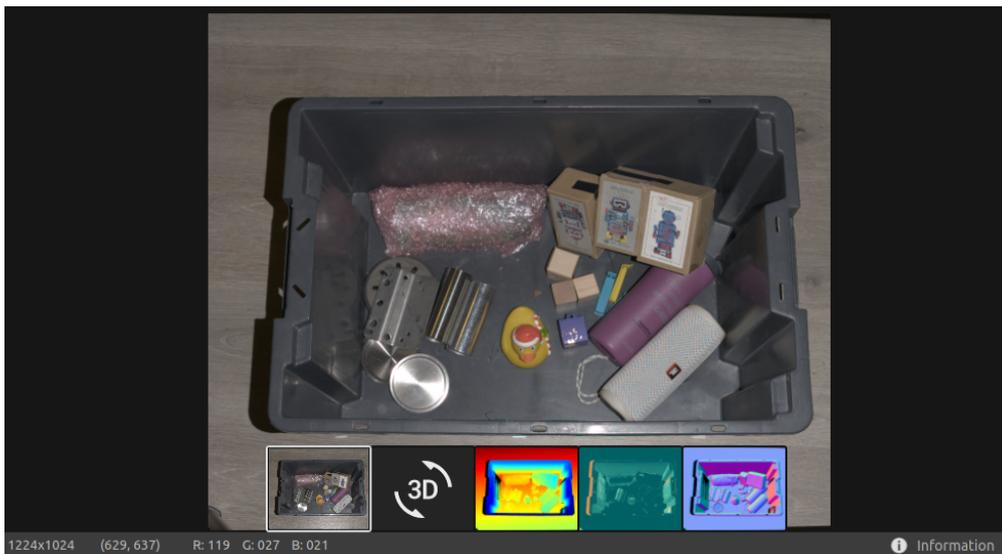
異なるピクセルサンプリングで2D + 3Dキャプチャを実行する場合、左上のドロップダウンで2Dキャプチャからの2D画像と3Dキャプチャを切り替えることができます。
