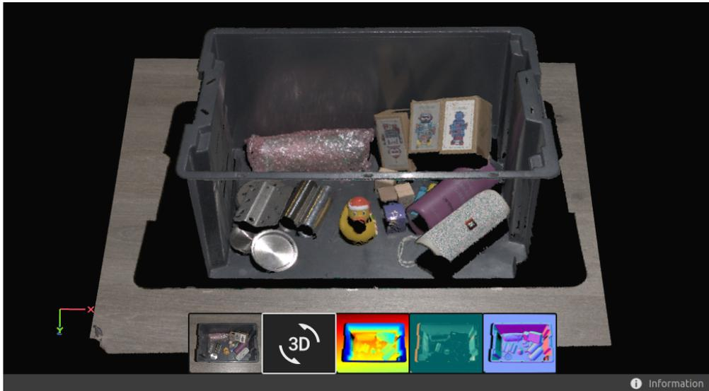
このビューでカラー (C、D、R) とメッシュ (M) をオン/オフにすると、点群の品質を評価するのに役立ちます。点のサイズも、左上のドロップダウンメニューから調整できます。ポイントサイズの調整は、たとえば、テクスチャが重要な領域を検査する場合に役立ちます。関心領域を有効にしている場合は、ドロップダウンメニューでその表示を変更することもできます。
