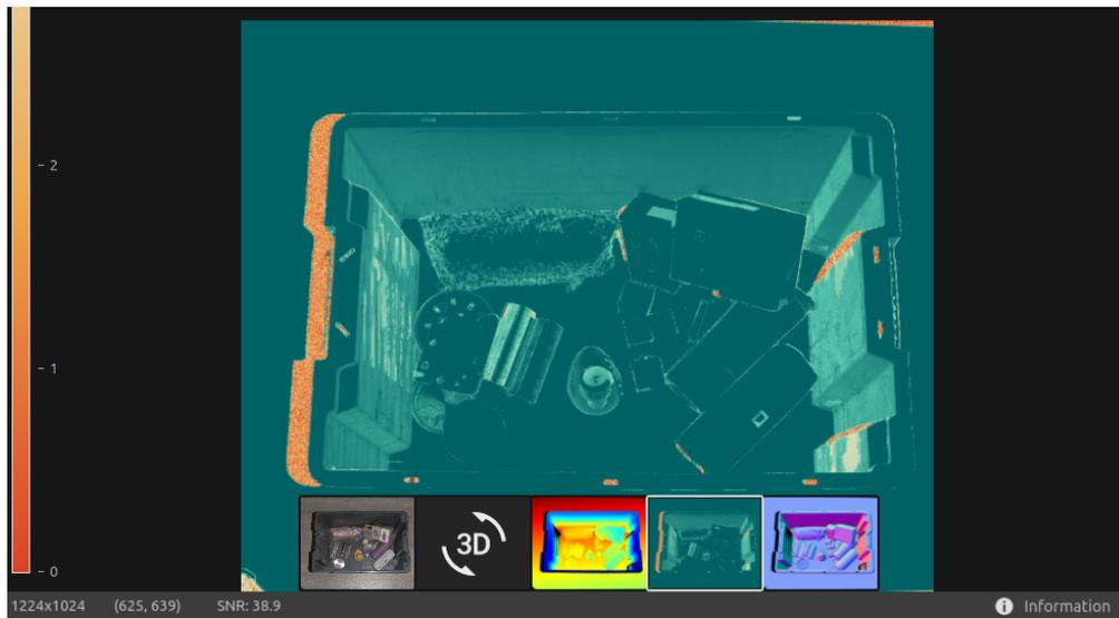
Die Farbskala stellt die Variation der [SNR-Werte](#) dar. Ein Pixel am oberen Ende der Farbskala stellt einen Punkt dar, der mit einer starken Signalqualität verbunden ist. Für einen Punkt, der mit einem Pixel am unteren Ende der Farbskala verbunden ist, ist das Verhältnis stärker vom Rauschen beeinflusst. Daher sind diese Punkte mit einer höheren Unsicherheit verbunden.
