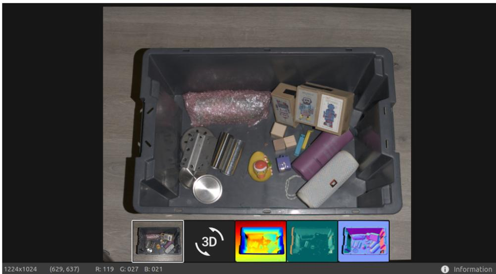
Wenn Sie eine 2D+3D-Aufnahme mit unterschiedlicher Pixelabtastrung durchführen, können Sie im Dropdown-Menü oben links zwischen dem 2D-Bild aus der 2D-Aufnahme und der 3D-Aufnahme wechseln.
