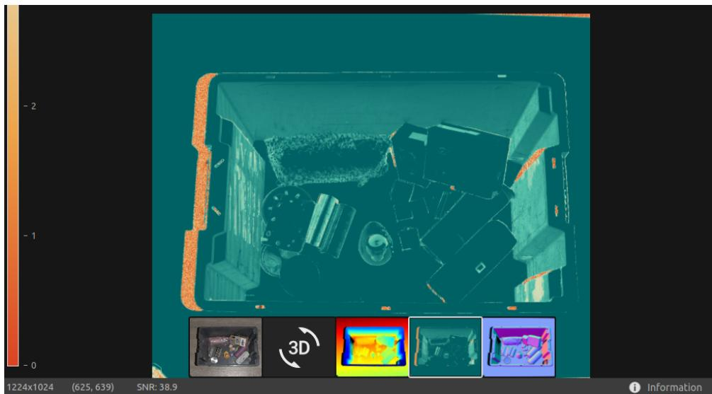
カラースケールは SNR 値 の変化を表します。カラースケールの上限にあるピクセルは、信号品質が高いことに関連付けられた点を表します。カラースケールの下限にあるピクセルに関連付けられた点の場合、比率はノイズの影響をより受けます。したがって、これらの点にはより高い不確実性が伴います。
