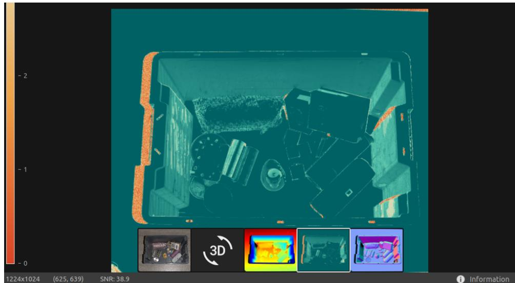
カラースケールは SN比値 の変動を表します。スケール上端のピクセルは信号品質が高い点を示し、下端のピクセルはノイズの影響が大きく不確実性が高い点を示します。
