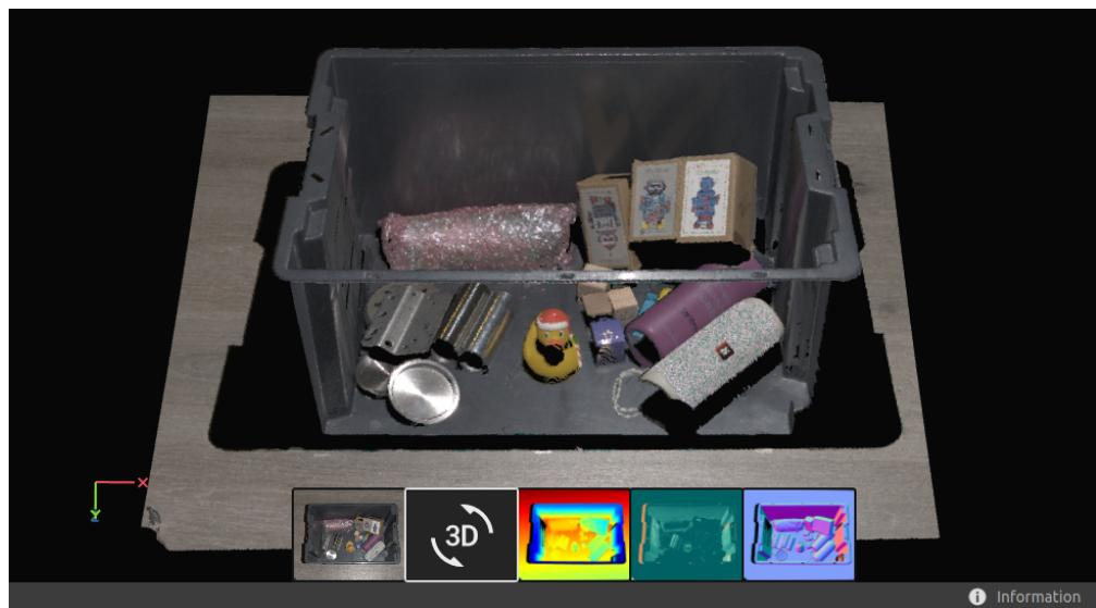
このビューでポイントクラウドの色付け方法 ( C、 D、 R および S ) を選択し、メッシュ ( M ) のオン/オフを切り替えると、ポイントクラウドの品質を評価するのに役立ちます。
