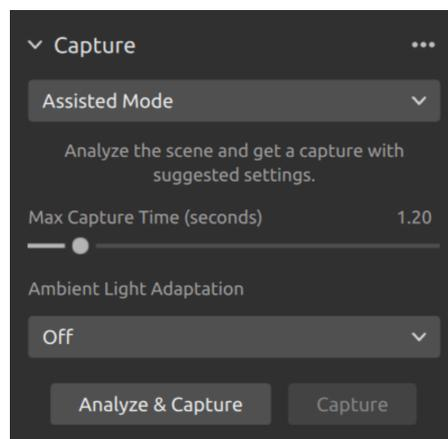
Dadurch beginnt die Kamera, die Szene zu analysieren und die erforderlichen Kameraeinstellungen zu ermitteln, um einen möglichst großen Teil des Dynamikbereichs der Szene abzudecken. Unmittelbar danach führt die Kamera eine zweite Aufnahme mit diesen Einstellungen durch.
