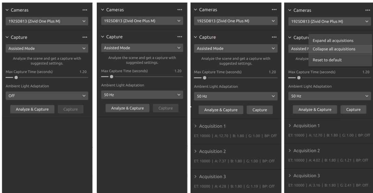
Die „Ambient Light Adaptation“ (Umgebungslichtanpassung) wird verwendet, wenn Umgebungslicht (mit Netzstrom) mit dem Projektorlicht der Kamera überlagert wird (Bloomingeffekt oder Übersättigung des Bildes).
